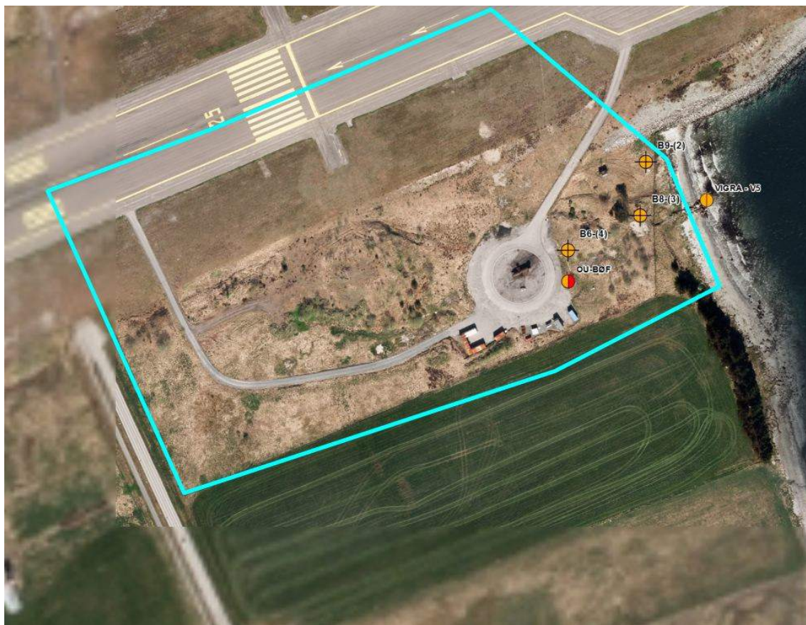
Figur 7-2. Viser nedbørsfelt til aktiv BØF markert med blått polygon. Brønnene er markert med sirkel med kryss.
