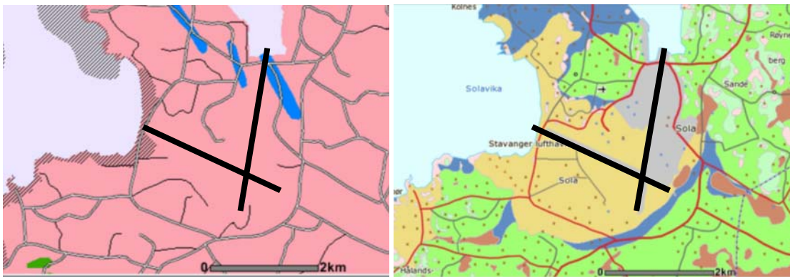
Figur 7. Geologisk kart for lufthavnområdet. Venstre: Berggrunnskart. Lys rød: diorittisk – granittisk gneis og migmatitt. Blå: marmor. Høyre: Løsmassekart: Lys brun: vindavsetning. Blå: marin strandavsetning. Grønn: tykt morenedekke. Rosa: bart fjell, tynt løsmassedekke. Grå: fyllmasse. Kilde: www.ngu.no . Rullebanene er angitt med sort linje.
