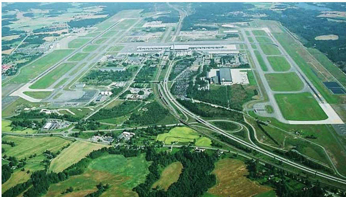
Figur 3. Oslo lufthavn Gardermoen. Gardermoenes to rullebaner med terminalbygget i midten. Taksebanene sees på innsiden av rullebanene. Foto: Oslo Lufthavn AS.
