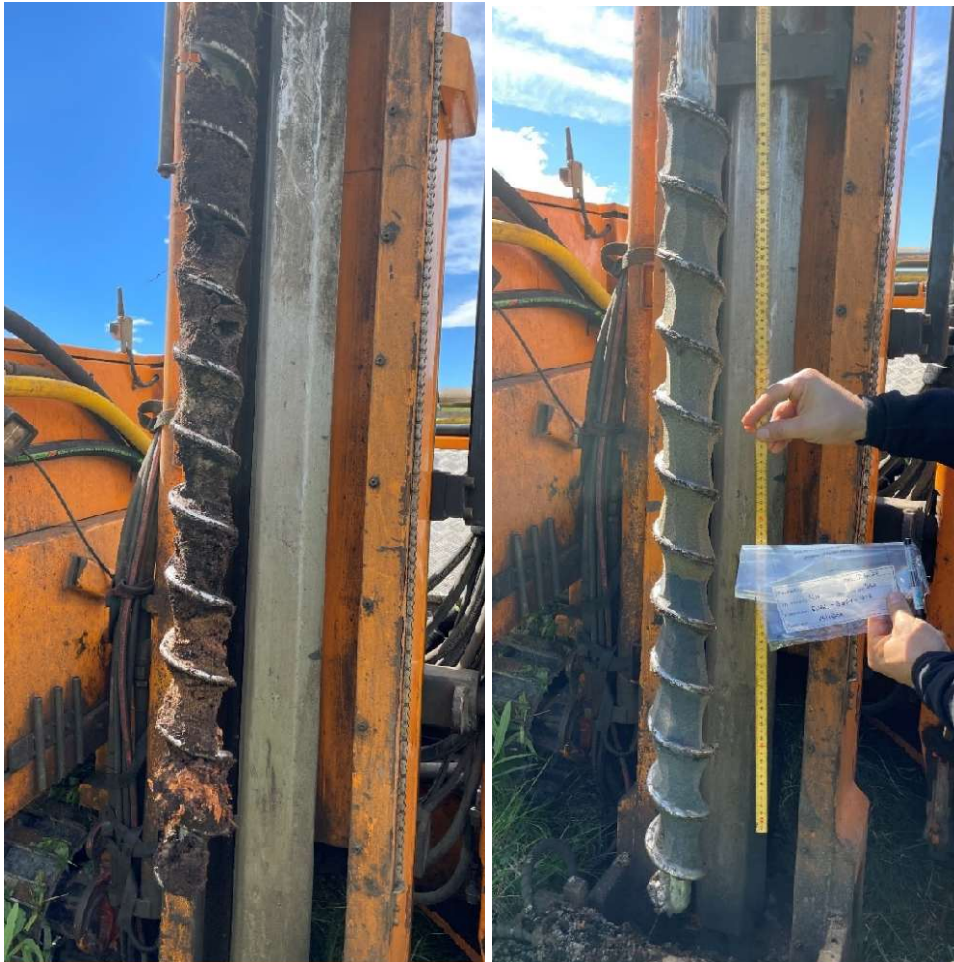
Figur 5-2: Bilder fra borepunkt BO8 som ligger nordøst for plattformen. Bilde til venstre viser masser av organisk rik jord 0-1 m under terreng, og bildet til høyre viser masser av fin sand/silt med innslag av leire fra 4-5 m under terreng.
