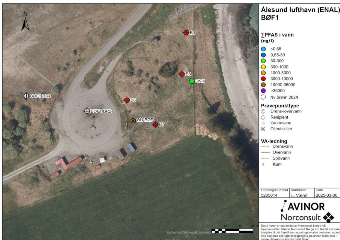
Figur 3-3: Børpunkter hvor det ble etablert grunnvannsbrønner, og prøvetatt grunnvann. Strømningsretning for grunnvann er mot øst.
