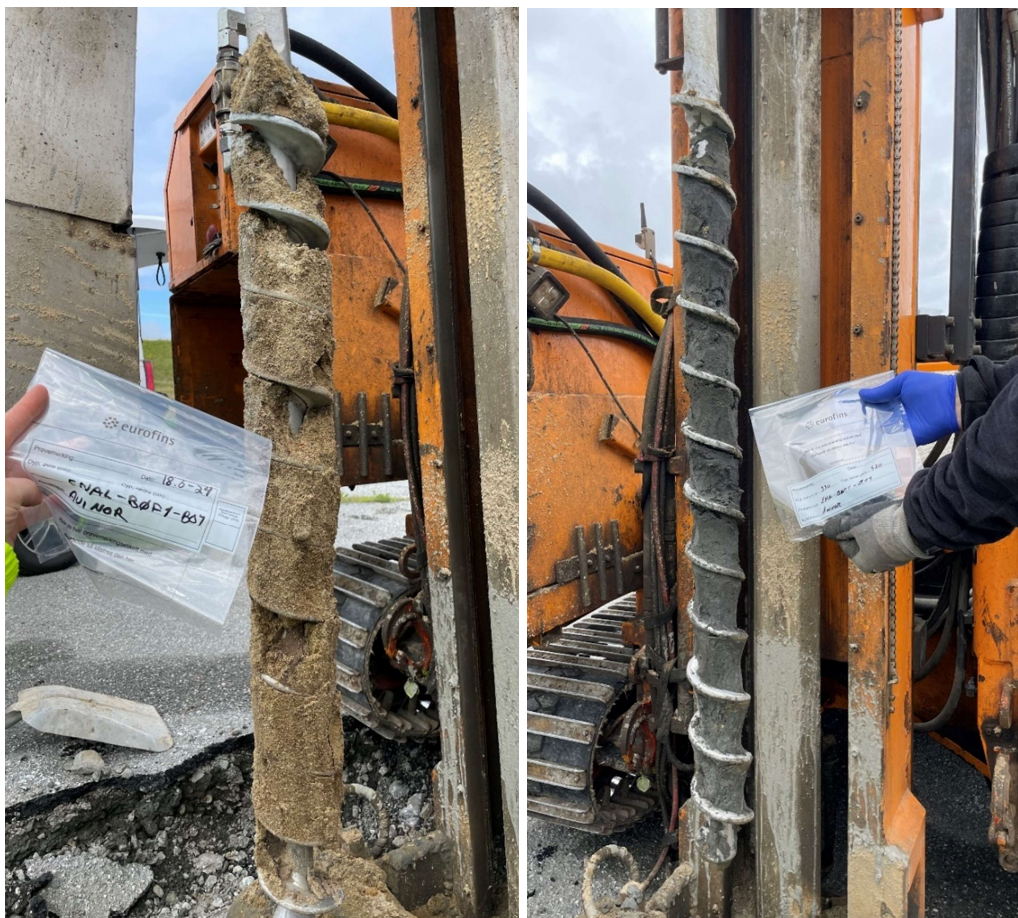
Figur 5-1: Bilder fra borepunkt BO1 under plattformen. Bilde til venstre viser masser av middels sand fra 0,5-1,5 m under terreng, og bildet til høyre viser masser av fin sand med innslag av leire fra 3,3-4,3 m under terreng.
