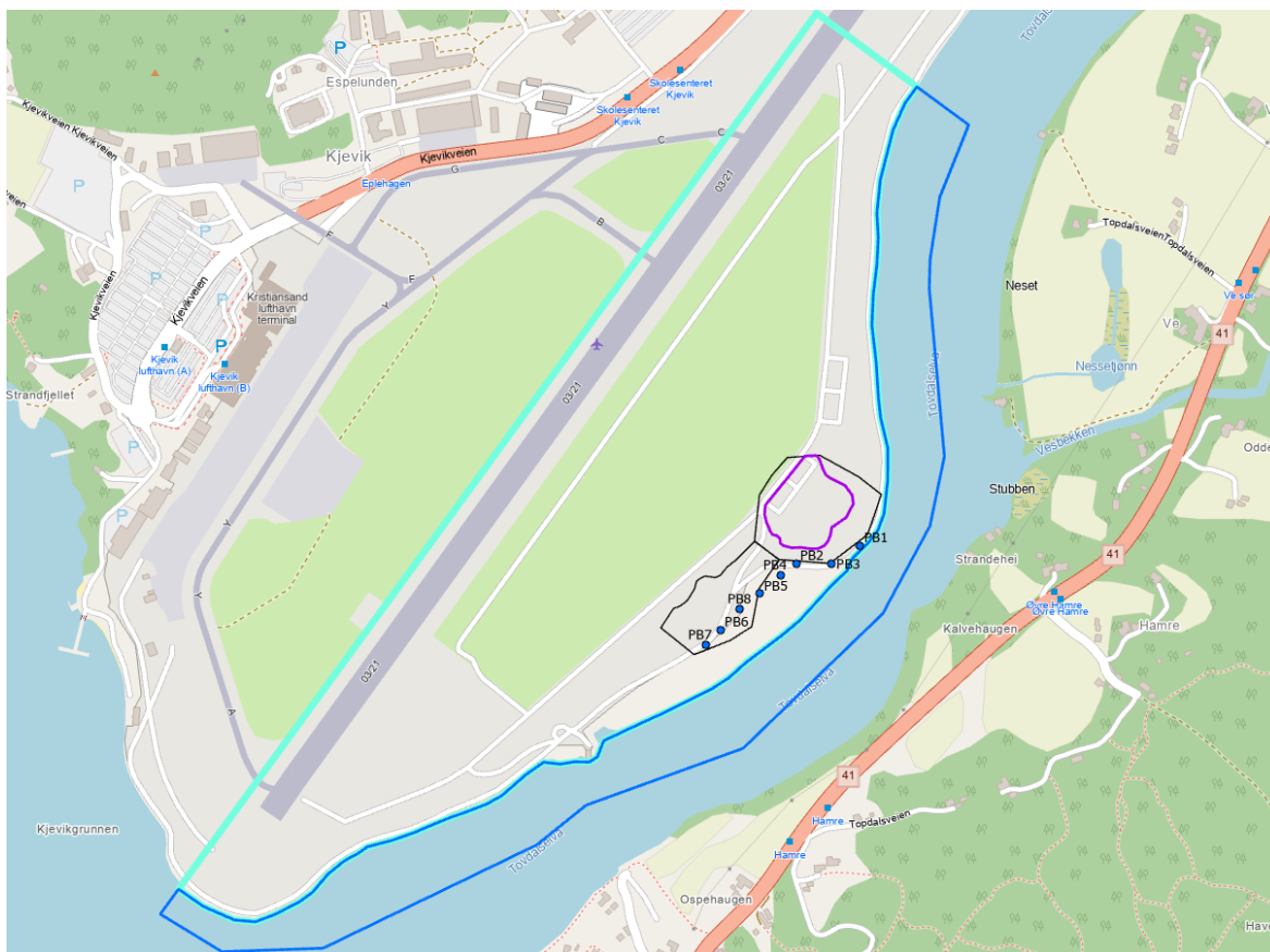
Figur 4-2: Tildelte grensebetingelser i modellen; lyseblå polygon – infiltrasjon (RCH); mørkeblå polygon – konstant trykktensial (CHD); lilla polygon – tiltak, tildekking i tidsavhengig simulering (RCH); blå punkter – tiltak, pumpebrønner i tidsavhengig simulering (FHB).
