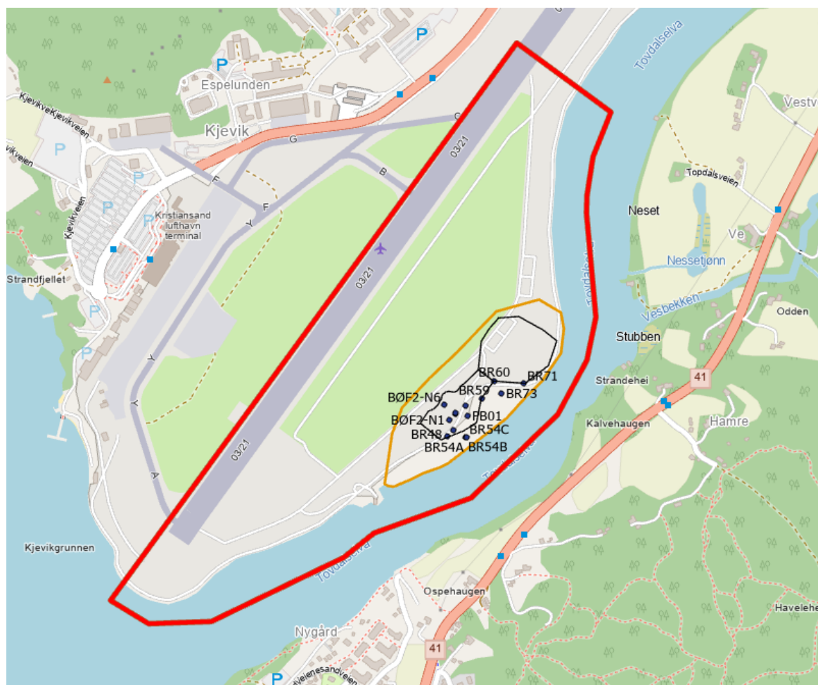
Figur 4-1: Modellens utstrekning er markert med rødt polygon. Svarte polygoner viser ca. plassering på BØF1 (nordøst) og BØF2 (sørvest), mens oransje polygon viser området der det er utført kornfordelingsanalyser og slug tester. Svarte punkter står for brønner der det er utført kornfordelingsanalyser/slug tester.
