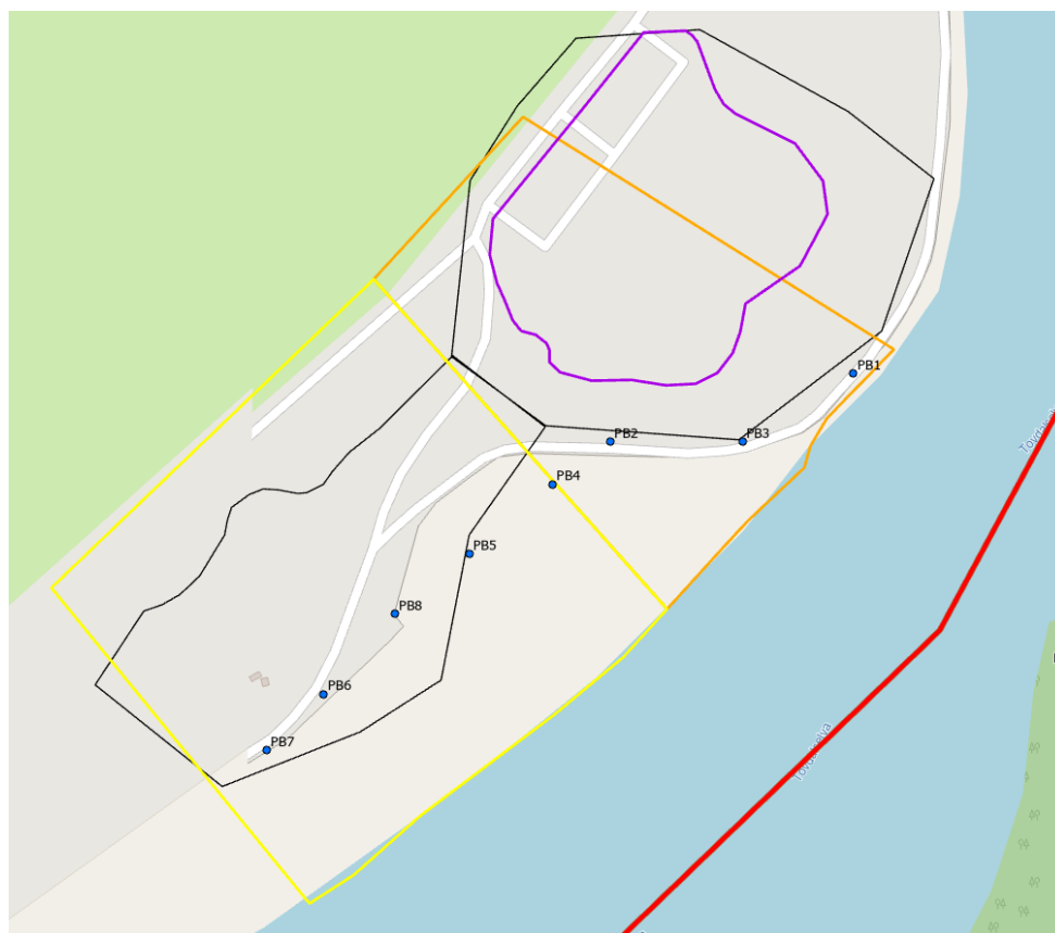
Figur 4-3: Polygoner som er brukt for beregning av mengde forurenset vann som pumpes ut; oransje polygon – utbredelsen av påvist forurensning >1000 ng/l ved BØF1; gul polygon - utbredelsen av påvist forurensning >1000 ng/l ved BØF2.
